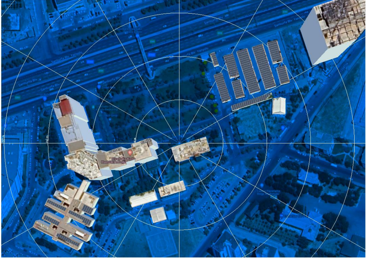
Şekil 4: Diyarbakır GYEA Kadın Doğum Hastanesi Çatı Üstü PV Kurulum Tasarım Görünümü
