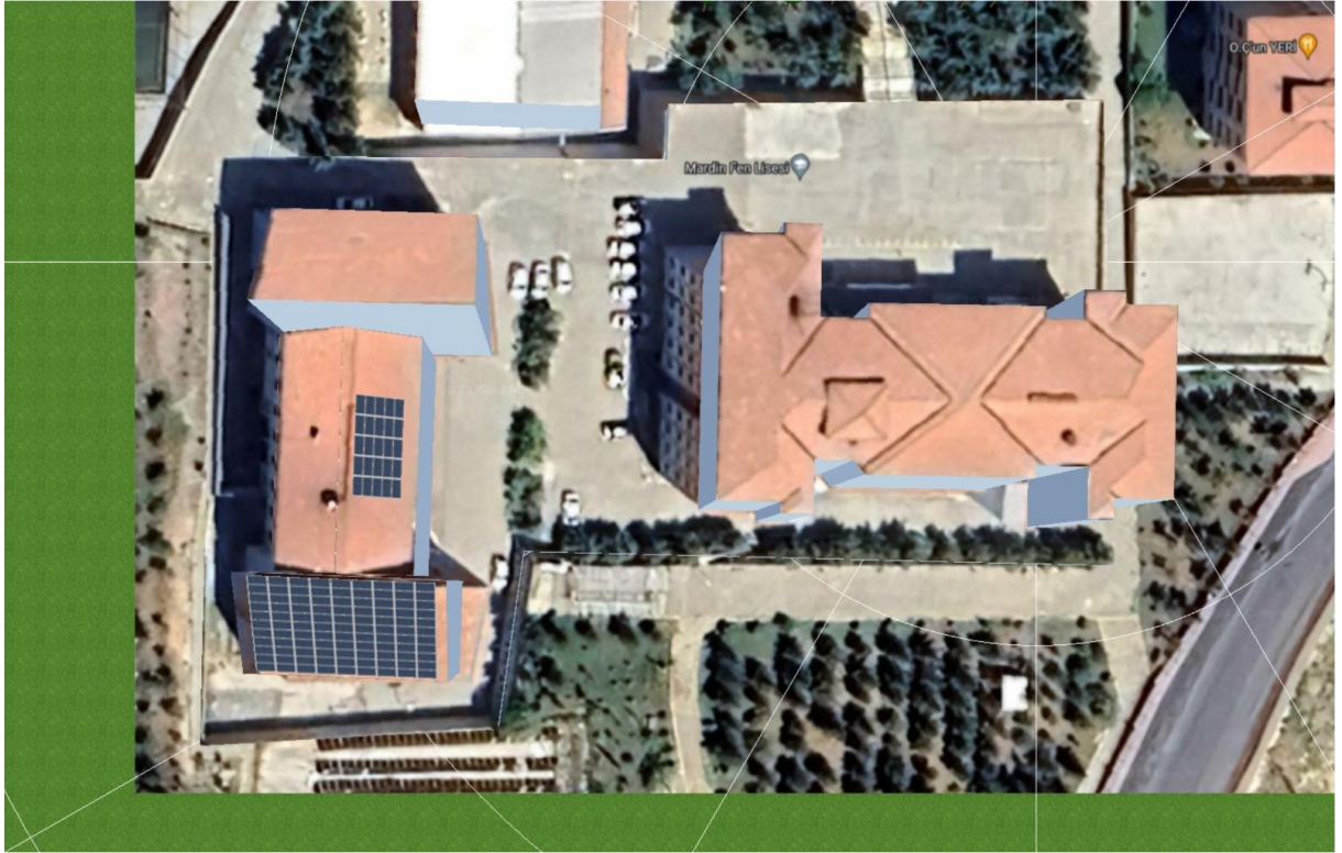
Şekil 5: Mardin Fen Lisesi Çatı Üstü 68,2 kWe PV Kurulum Tasarım Görünümü
