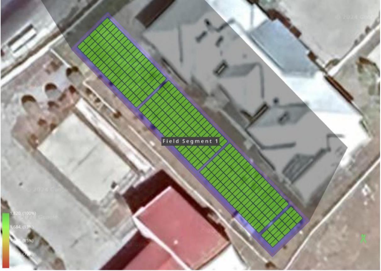
Şekil 5: Okul Bahçesi Açık Alanına GES Uygulaması- Panellerin Yerleşimi
