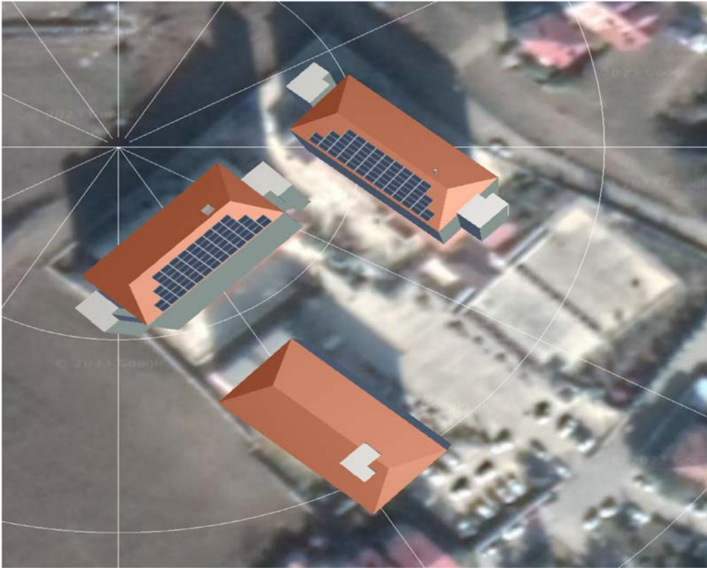
Fotođraf 12. Vezirköprü Hatice Kemal Kayalıođlu Fen Lisesi Çatı Üstü PV Kurulum Tasarım Görünümü
